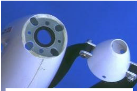
Tirando il collo al proprio motore è meglio provvedere ad una adeguata ventilazione. L'immagine mostra una soluzione adeguata Ottenuta tornendo l'ogiva metallica.
